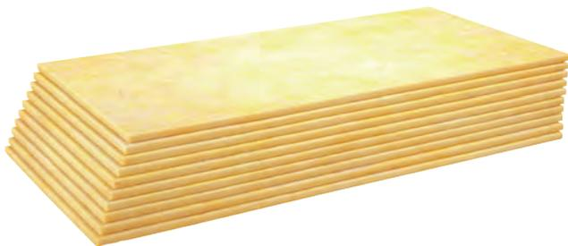
ガラス繊維の密度を高めた、ボード状の高密度グラスウールです。フェザーグラスより機械的強度があり、荷重を負担する屋根下地、コンクリート下地などに利用できます。
