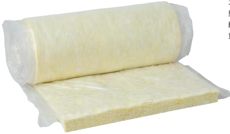
フェザーグラスをポリエチレンフィルムで覆った、二重折板屋根専用の断熱材です。二重折板屋根は大型工場など、広面積で人の出入りが多く、居住性を配慮した鉄骨造にみられる工法で、ポリラップは二重折板屋根の内部に施工されます。
